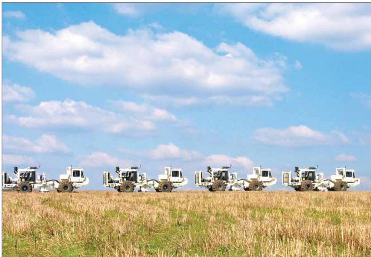
Ново поколение сеизмични Вибратори I/O AHV - IV 362 за 2-D и 3-D сеизмични изследвания
