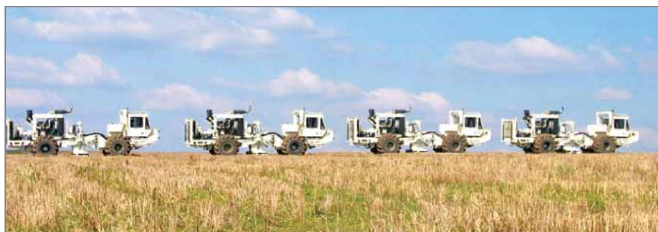
Ново поколение сеизмични вибратори I/O AHV - IV 362 за 2-D и 3-D сеизмични изследвания
