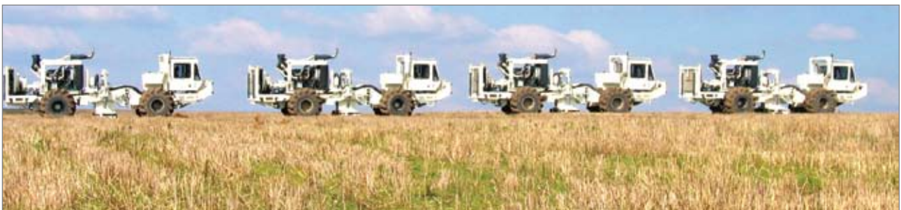
Ново поколение сеизмични вибратори I/O AHV - IV 362 за 2-D и 3-D сеизмични изследвания
