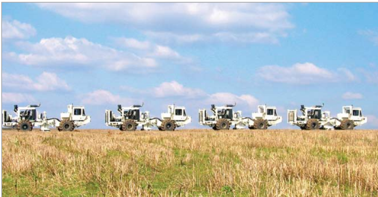
Ново поколение сеизмични вибратори I/O AHV - IV 362 за 2-D и 3-D сеизмични изследвания
