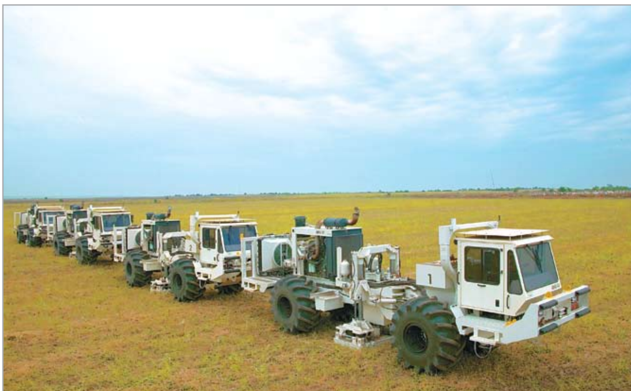
Ново поколение сеизмични вибратори I/O AHV - IV 362 за 2-D и 3-D сеизмични изследвания
