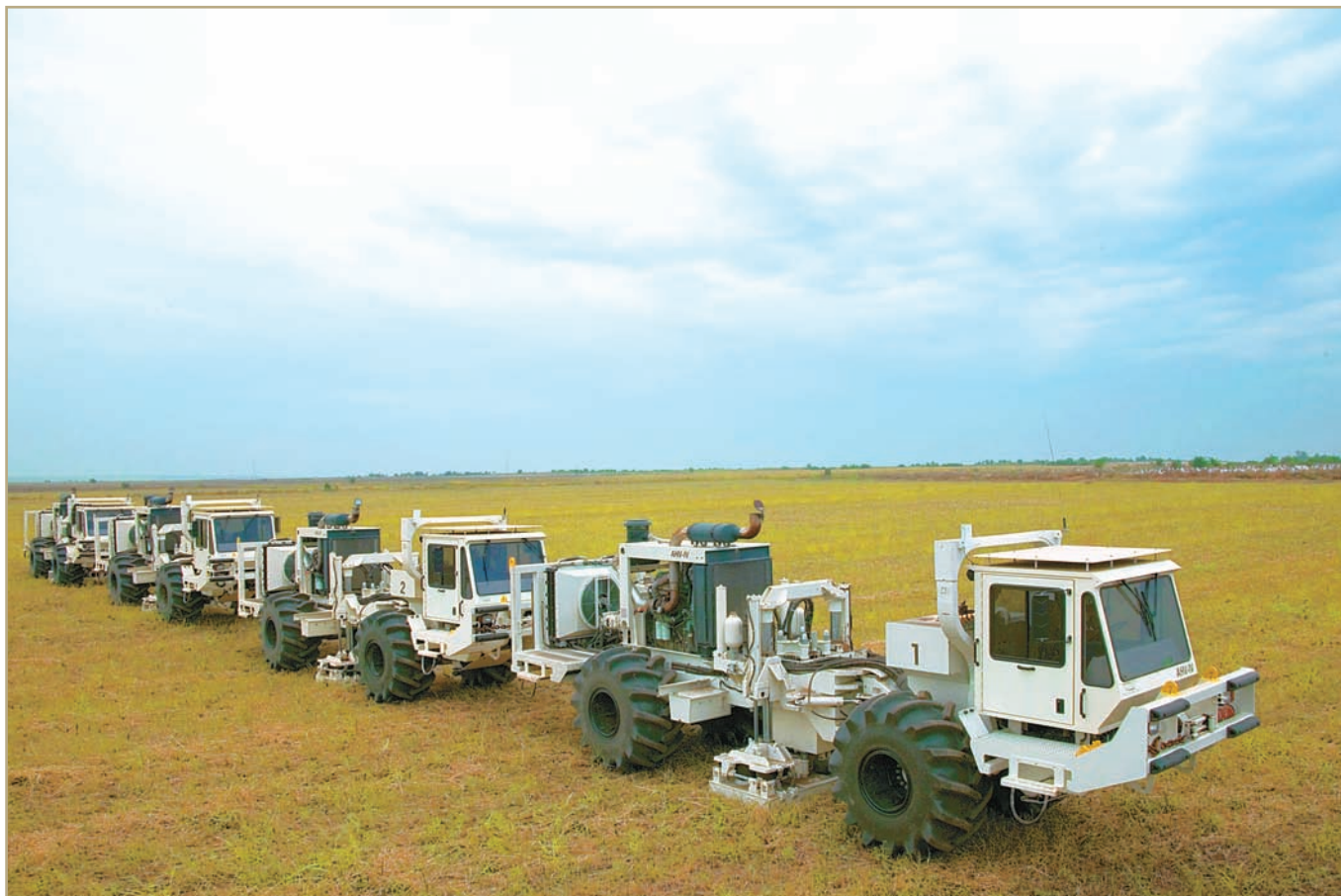
Ново поколение сеизмични вибратори I/O AHV-IV 362 за 2-D и 3-D сеизмични изследвания
